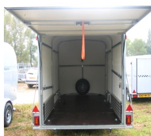
Ouverture totale auvent avec vérins compensateurs
