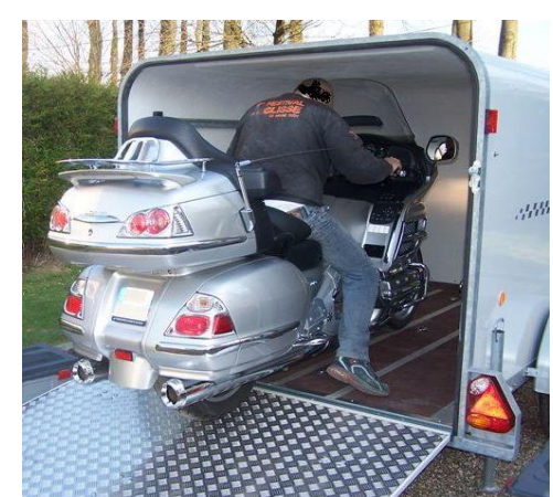
Ouverture totale pont avec vérins compensateurs
