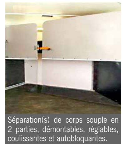
Plancher polyéthylène imputrescible et antibruit.
